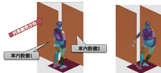
(a) 車内設備1と衝突時 (b) 車内設備2と衝突時
