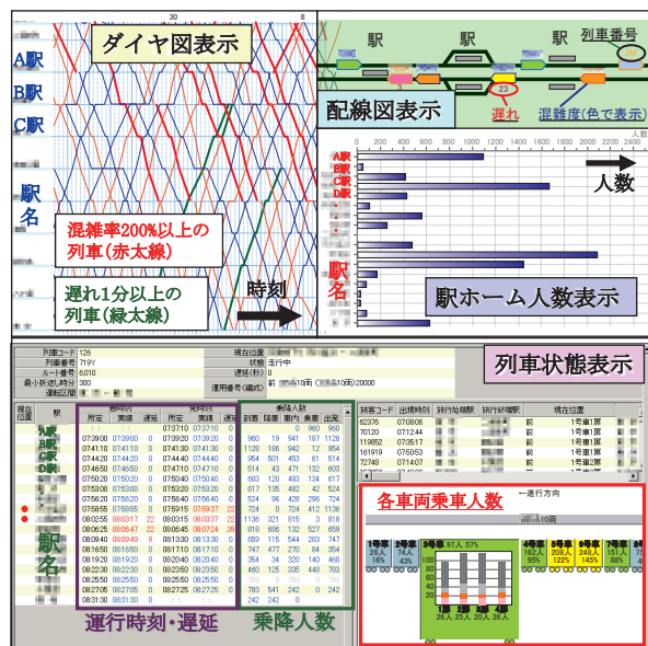
図2 列車運行・旅客行動シミュレータの出力例
