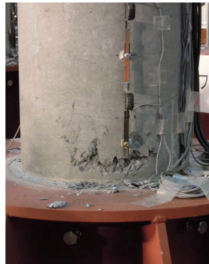
図 18 1000Gal 加振後の H 形鋼を挿入した PC 電化柱
