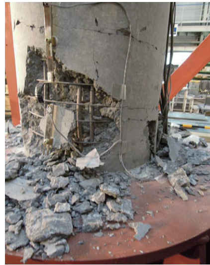
図 17 1000Gal 加振後の無対策 PC 電化柱
