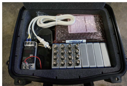
図3 輪重横圧測定処理システム機器
