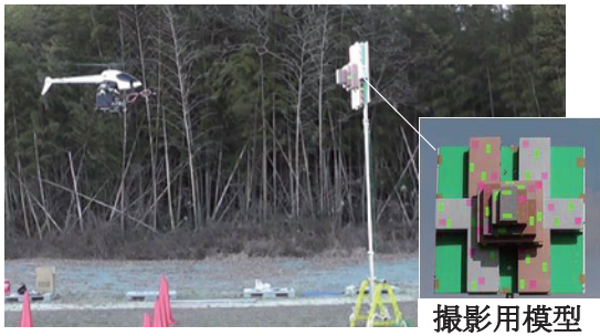
図4 空撮実験状況ならびに撮影用模型
