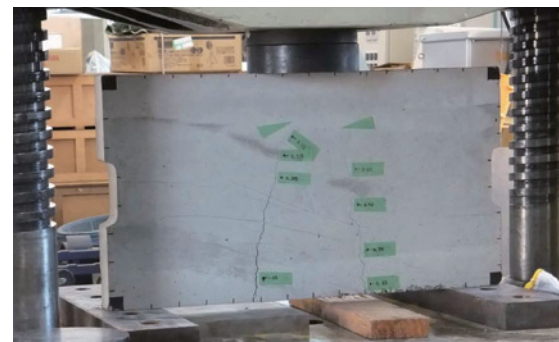
図16 载荷試験機によるひび割れ発生加速試験
