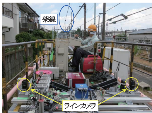
図9 集電試験装置における測定試験状況
