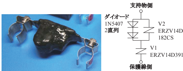
図10 現地模擬地絡試験で使用した試作保護線用素子
