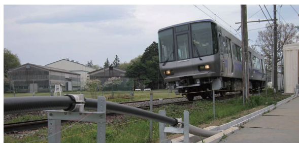
図3 超電導き電ケーブルを用いた列車走行試験
