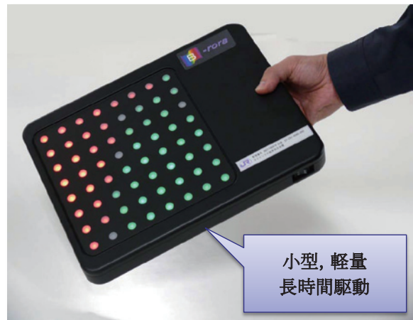
図5 開発した磁界可視化装置
