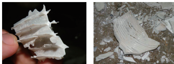
図 3 導体と樹脂の剥離状況
