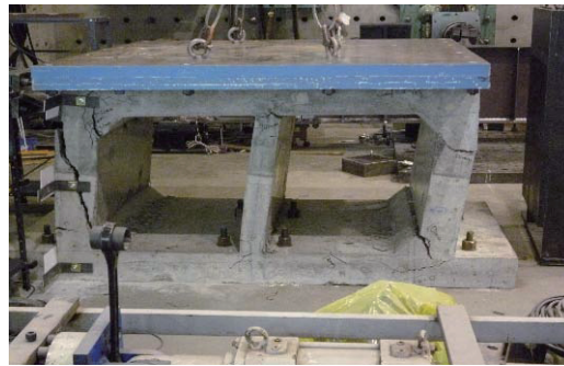
(b) 損傷状況(相対変位:約82mm)
