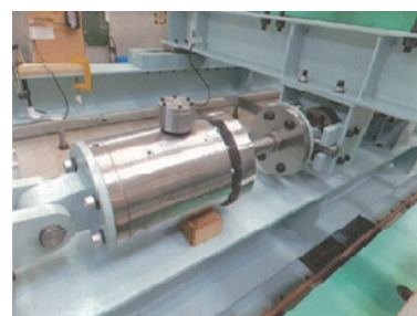
図5 慣性質量ダンパ設置状況
