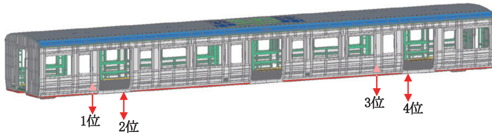
図6 一車両構体モデルおよび境界条件
