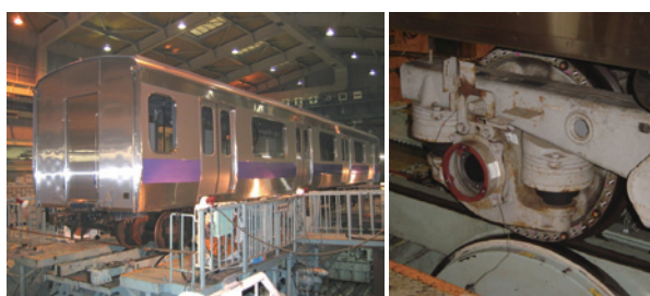
(a) 全景 (b) 車輪と軌条輪 図4 車両試験台加振試験の状況
