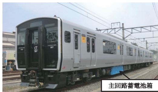
図1 蓄電池電車（試験車）の外観
