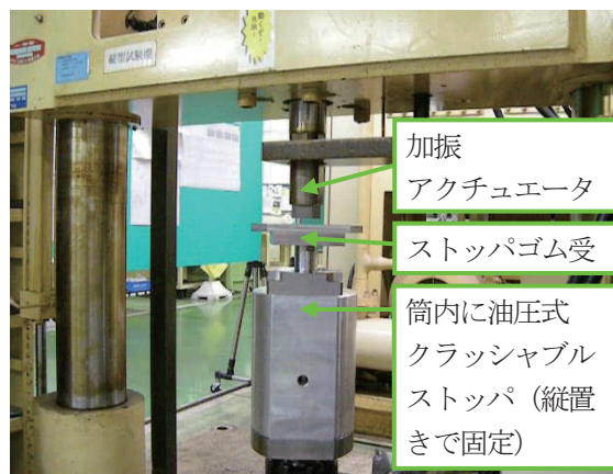
図4 静荷重試験状態
