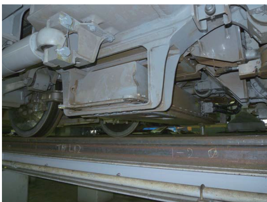
図2 慣性正矢軌道検測装置（九州新幹線）
