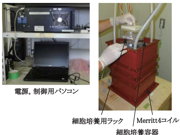
図1 中間周波磁界曝露装置
