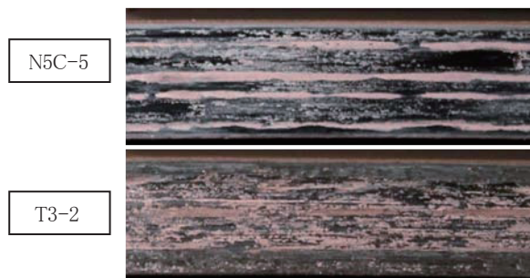
図7 パンタグラフ総合試験装置での試験後の模擬トロッコ線摩擦面
