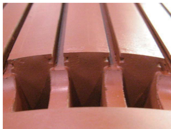
図 2 試作機の回転子スロット部
