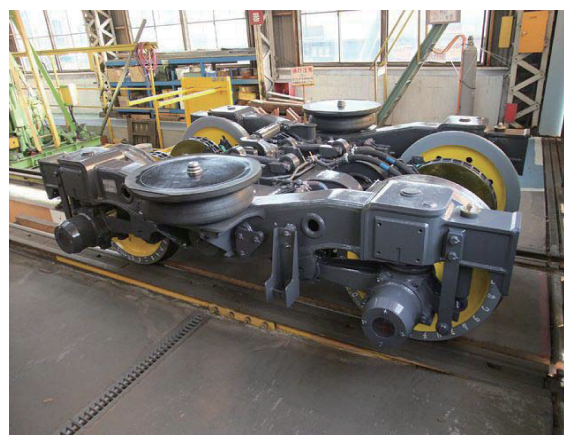
図1 輪重減少抑制台車の外観
