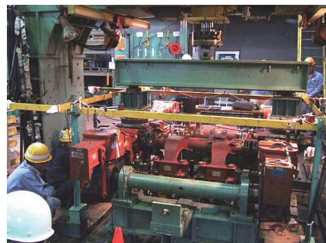
図7 回転抵抗調査試験
