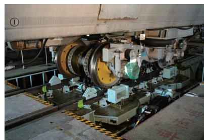
図1 試験装置の外観（供試台車積載状態）
