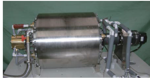
図1 中部電力などが開発した磁気冷凍機 10)
