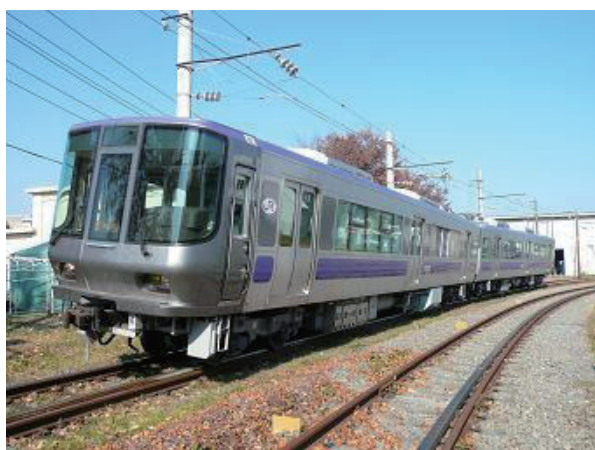
図5 燃料電池・バッテリーハイブリッド試験電車
