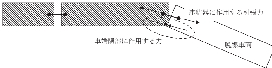
図7 編成車両の脱線逸脱時の状況例
