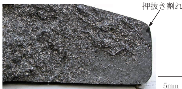
図 5 レールガス圧接試験体の破断面状況（底部端）
