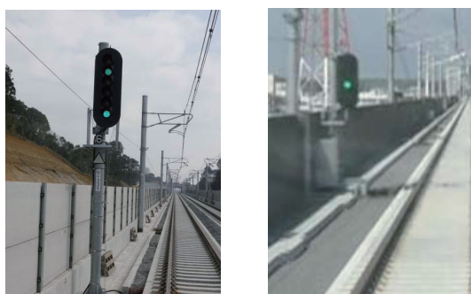
図1 信号現示例(高速進行(GG):左,進行(G):右)
