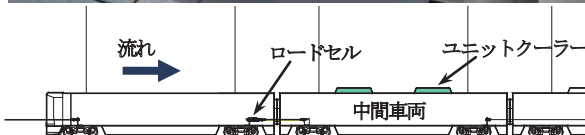
図 2 空気抵抗測定状況（ユニットクーラー改良）
