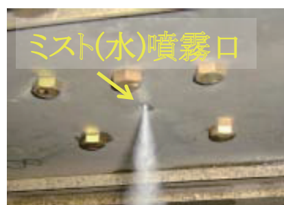
図4 レーザー照射口(上図)およびミスト噴霧口(下図)
