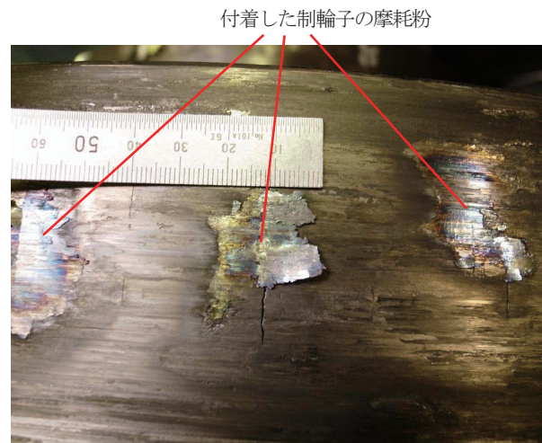
図10 車輪踏面の摩耗粉の付着
