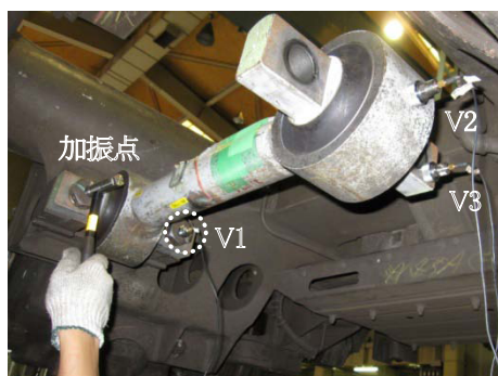
図 12 検修作業時に想定される試験状況
