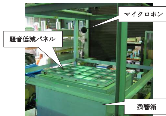
図3 残響箱を用いた騒音低減試験
