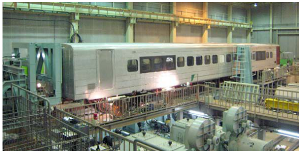
図4 車両試験台による加振試験
