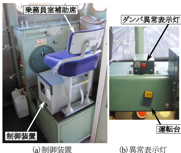
図 17 異常検知手法を搭載した制振制御システム
