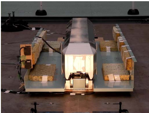
図9 振動台での定置時の動的転覆試験
