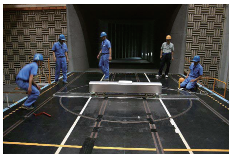
図5 縮尺 1/10 車両模型による風洞試験
