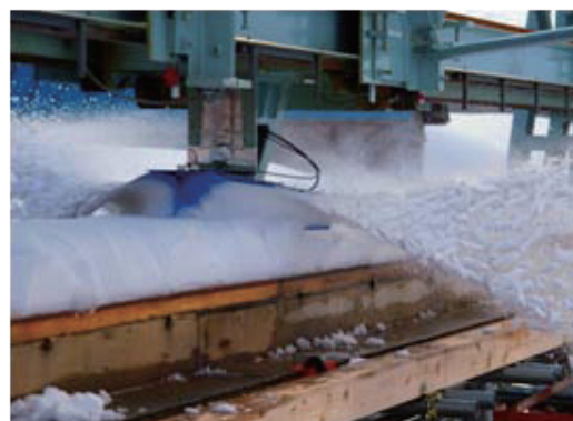
図2 模型スノーブラウによる排雪抵抗力評価試験
