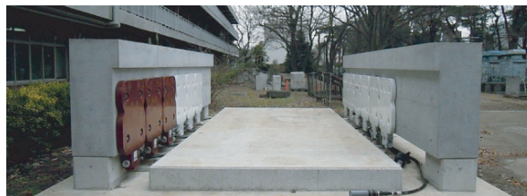
図10 施工性検証用模擬側壁
