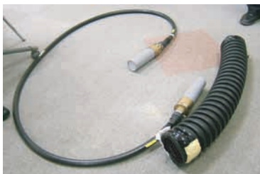
図20 ヌルフラックスケーブルと採用したFEP管
