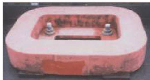
図7 宮崎実験線浮上コイル
