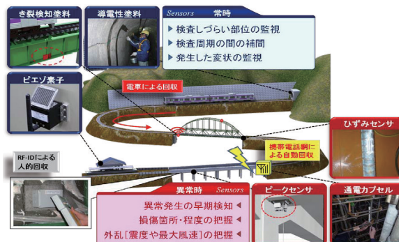
図7 構造物のヘルスマonitoringシステム
