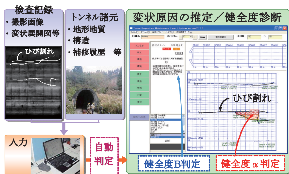
図6 トンネル健全度診断システム
