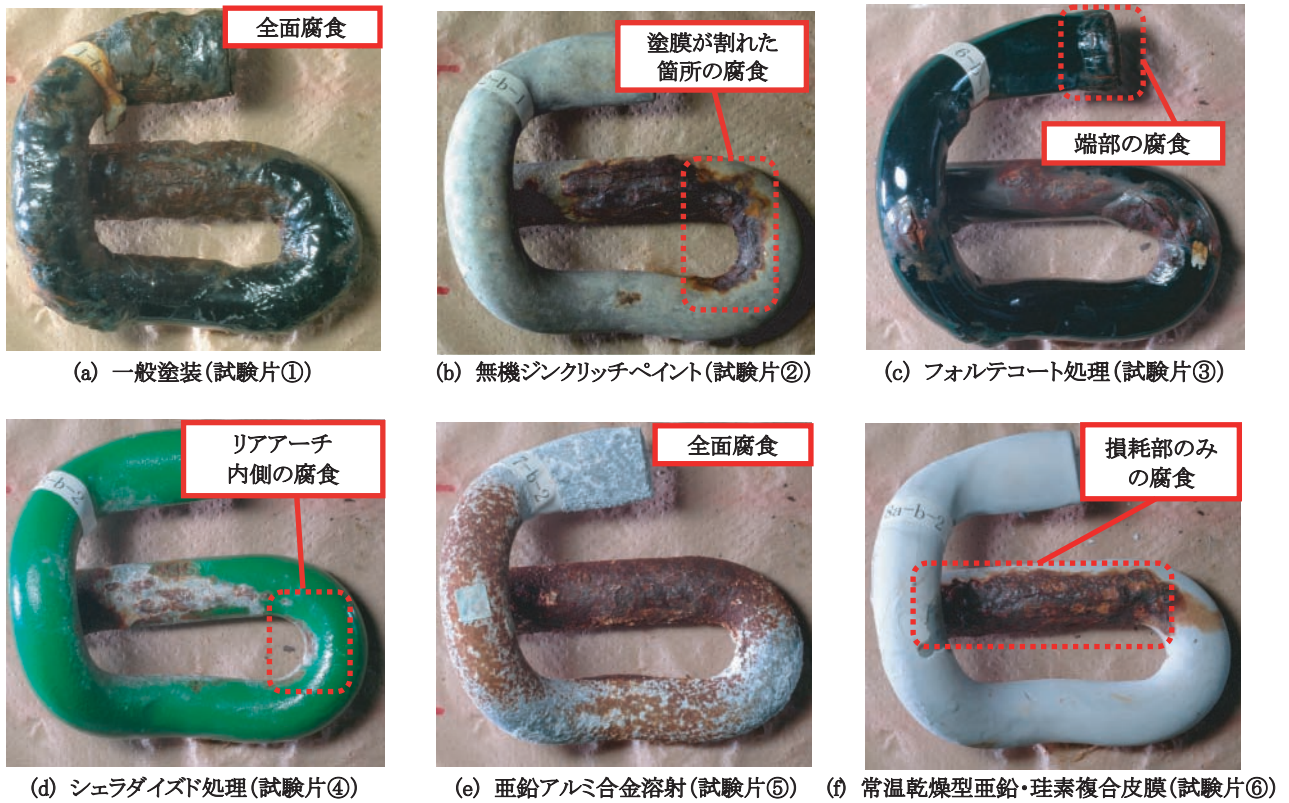
図2 促進腐食試験後の試験片の状態
