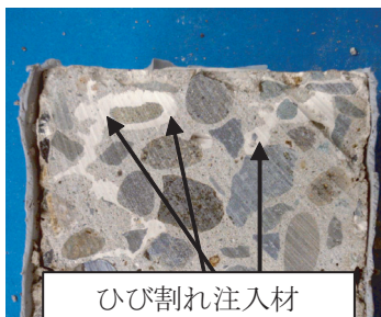
図10 模擬ひび割れ注入状況
