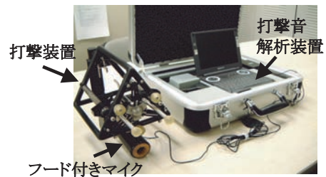
図9 総研式打音検査装置
