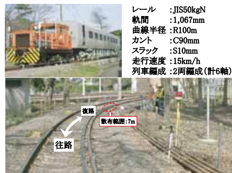
図7 構内試験線における走行試験の概要
