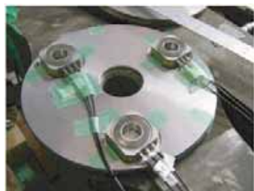
(b) 空気ばね／台車枠間への取り付け
