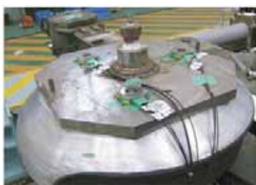
(a) 空気ばね／荷重枠間への取り付け
