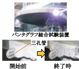
図6 三孔管に対する離線アークの影響評価結果
