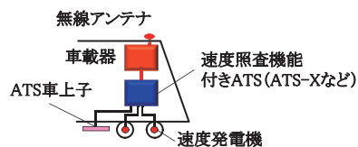
図3 車上設備の基本システム構成
