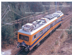
図5 検測車両と検測装置 14)
