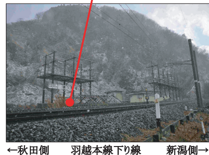
図4 勝木塩害実験所におけるハンガイヤー試作品の暴露試験状況
