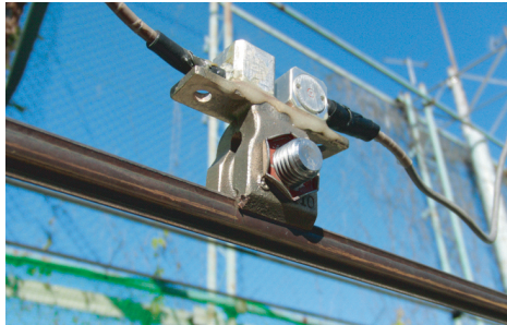
図2 トロリ線の加速度計取付け状況
